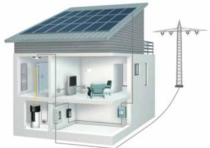
Toplotna pumpa u vezi sa fotonaponskim solarnim sistemom
